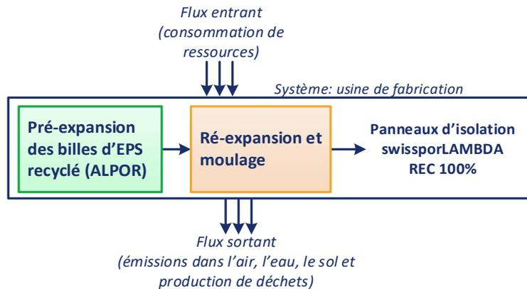
Schéma simplifié des procédés de fabrication (étapes A1 à A3)
