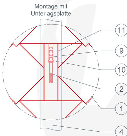
Bei PREFA Dachraute 44x44 ist es erforderlich eine Unterlagsplatte einzubauen, um den PREFA Schneerechenhaken montieren (zb. wenn ein Falz im Montagebereich über dem Sparren liegt)
