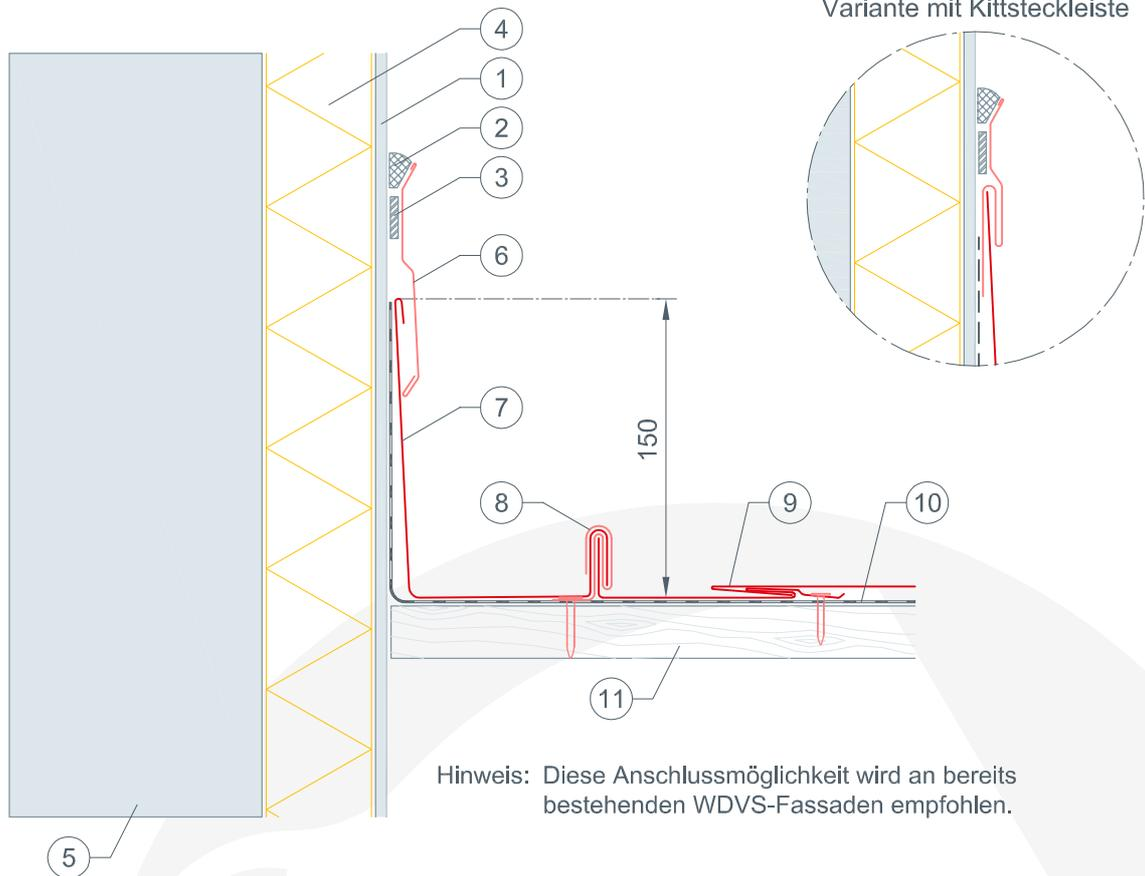
Hinweis: Diese Anschlussmöglichkeit wird an bereits bestehenden WDVS-Fassaden empfohlen.
