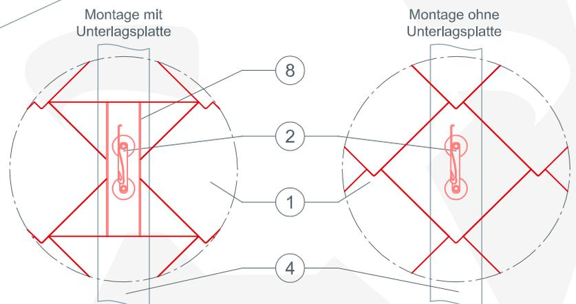
Bei kleinformatigen PREFA Dachelementen kann es erforderlich sein eine Unterlagsplatte einzubauen, um den PREFA Sicherheitsdachhaken zu montieren (z.B. wenn ein Falz im Montagebereich über dem Sparren liegt)
