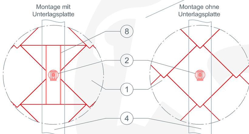
Bei kleinformatischen PREFA Dachelementen kann es erforderlich sein eine Unterlagsplatte einzubauen, um den PREFA Solarhalter Vario oder Fix zu montieren (zb. wenn ein Falz im Montagebereich über dem Sparren liegt)
