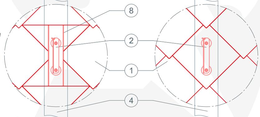
Bei kleinformatigen PREFA Dachelementen kann es erforderlich sein eine Unterlagsplatte einzubauen, um den PREFA Gebirgsschneefang Stütze zu montieren (zb. wenn ein Falz im Montagebereich über dem Sparren liegt)
