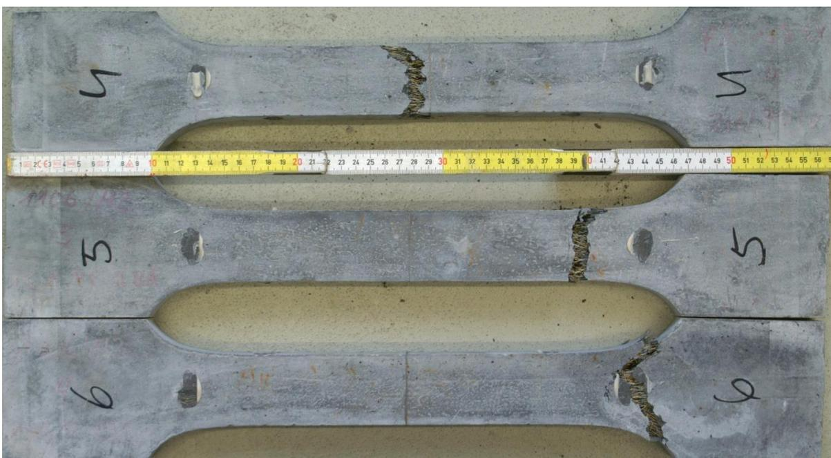
Abb. A2: Prüfkörper 4 – 6 nach der Prüfung. Prüfkörper 5 und 6 mit Riss ausserhalb  $l_{mes,1}$ .
