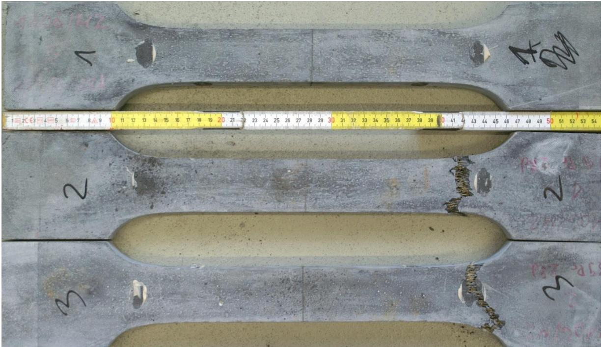
Abb. A1: Prüfkörper 1 – 3 nach der Prüfung. Prüfkörper 1 ohne Riss (aus der Klemmbanke ausgezogen), Prüfkörper 2 und 3 mit Riss ausserhalb  $l_{mes,1}$ .
