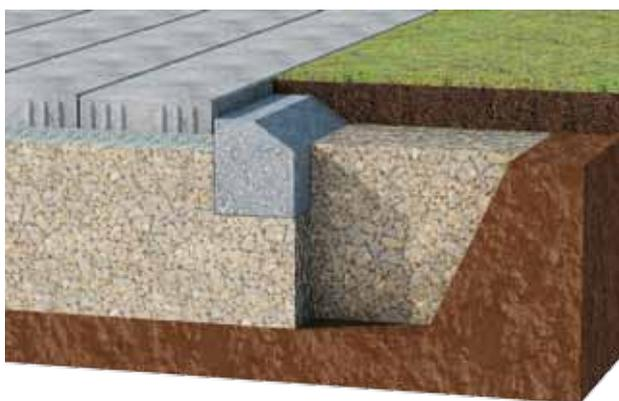
Figure 31: Bétonnage de bordure in situ
