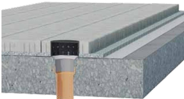
Figure 18: Drainage des toits plats et des terrasses
