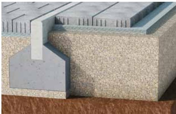
Figure 28: Transition avec bordurette en béton
