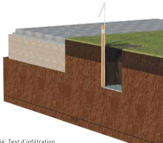
Figure 54: Test d'infiltration
