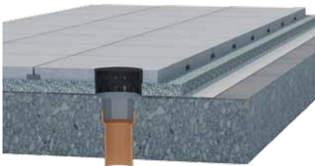
Figure 47: Drainage des toits plats et des terrasses
