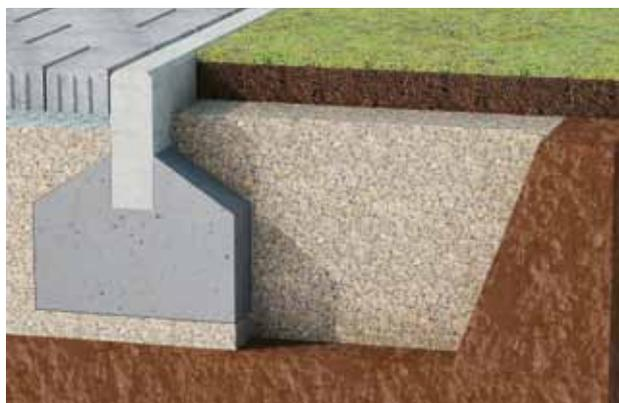
Figure 30: Transition avec une bordurette en béton
