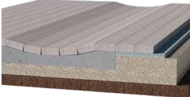
Figure 17: Caniveau de drainage en pavés
