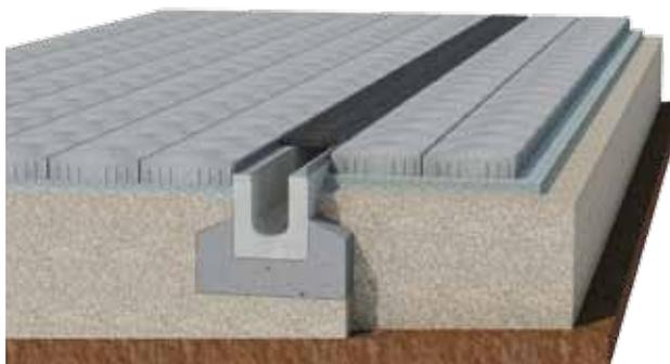
Figure 33: Caniveau de drainage dans le pavage
