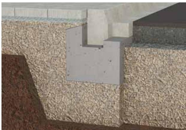
Figure 11: Transition avec bordures et pavés de marquage
