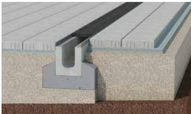
Figure 15: Caniveau de drainage dans le pavage
