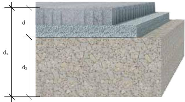
Figure 53: Détermination de l'épaisseur de la superstructure
