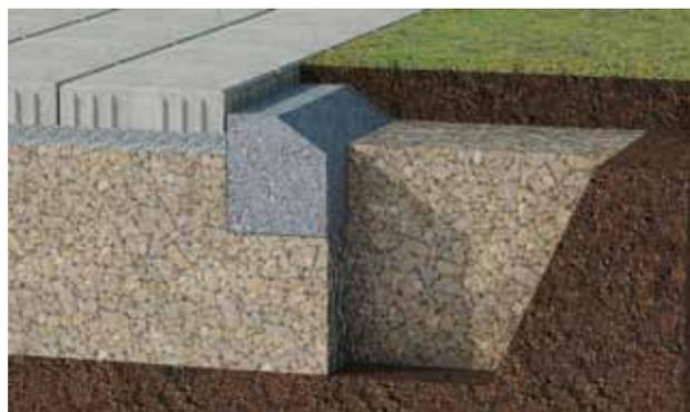
Figure 13: Bétonnage de bordures in situ
