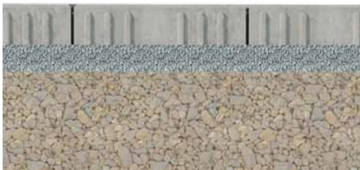
Figure 3: Coupe détaillée de la superstructure
