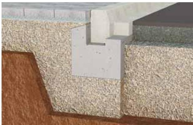
Figure 29: Transition avec bordure et pavés de marquage
