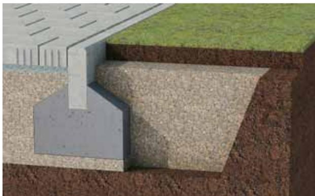
Figure 12: Transition avec une bordurette en béton
