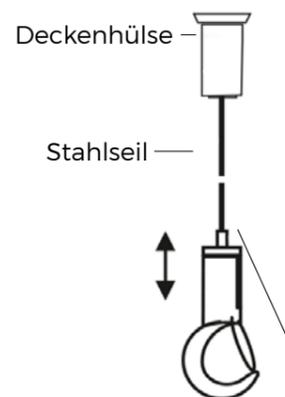
Deckenhülse an Decke befestigen, Stahlseil in Deckenhülse schieben (Kugel als Anschlag), Hülse anschrauben. Freies Stahlseilende in Befestigungshaken einfädeln und auf Abhängehöhe justieren.
