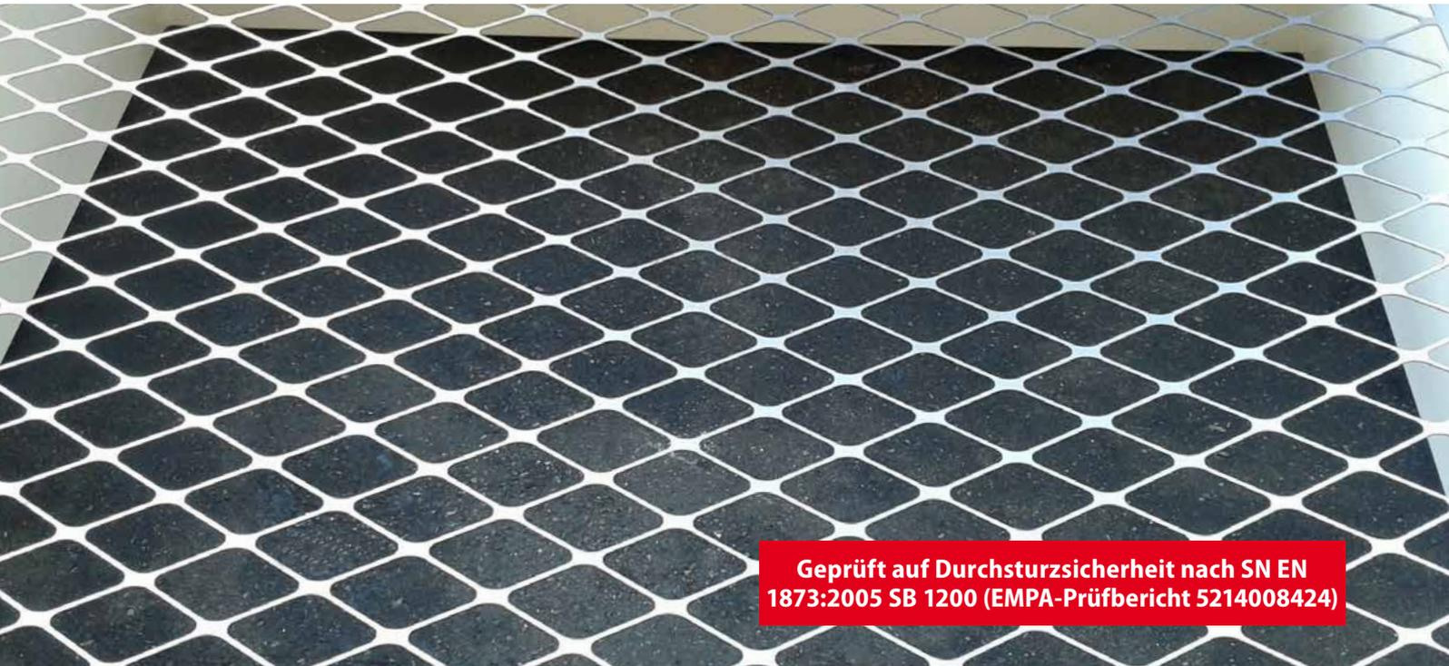
Geprüft auf Durchsturzicherheit nach SN EN 1873:2005 SB 1200 (EMPA-Prüfbericht 5214008424)
