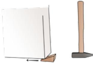
10. Danach lässt sich der Fusspunkt des Elements zunächst mit Holzkeilen in Längs- und Querrichtung grob fixieren, um es schließlich mit einer langen Wasserwaage auch lot- und fluchtrecht auszurichten.
