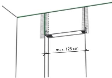
13. Die Breite der Türöffnungen sollte 125 cm nicht überschreiten. Hierbei kann das Sturzelement passend aus den TWE zurechgeschnitten werden. Die Sturzplatte wird mit Hilfe von Stahlwinkeln an den benachbarten TWE verankert. Auf einer Seite wird die Stossfuge regulär vermörtelt, auf der anderen Seite als Dehnungsfuge mit Polyesterolschaum ausgeschäumt. Die Fugen müssen zum Schluss mit Netzeinbindung verputzt werden.
