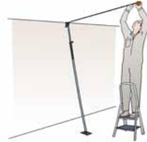
3. Markieren Sie im ersten Schritt die Position der Trennwände mit einer Schlagschnur.
