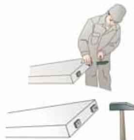
8. Vor der Montage der Elemente werden zwei Gummiblöcke an der Oberkante des Elements angebracht, um eine Dehnungsfuge von der Decke auszubilden und vor Rissbildung durch Durchbiegung zu schützen. Zusätzlich sollten zwei Gummiblöcke an der Seitenkante des ersten Elements angebracht werden, um eine Dehnungsfuge zwischen dem Element und der Wand zu schaffen.
